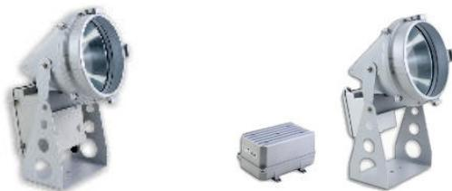
Die Linse besteht aus gehärtetem Silikatglas um mechanischen und thermischen Belastungen zu trotzen und entspricht den gesetzlichen Sicherheitsanforderungen der Normen BS 3193 und UNI 7142. Schutzgrad IP65. Die Punto-Serie ist für die szenische Außenausleuchtung von Objekten entwickelt worden. Der enge Abstrahlwinkel ermöglicht eine starke Betonung auch von entfernten Objekten. Ideal zur Beleuchtung von Hotels, Einkaufszentren, Firmen, Villen und Gärten.
