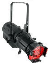
Der **Ovation E910FC** ist ein Profilier mit RGBA-Lime LED Lichtquelle. 91 LEDs mit je 3 Watt (18xrot, 18xgrün, 19xblau, 18xamber, 18xlime) erzeugen in 16-bit Auflösung feinste Farbnuancen. Presets mit Farbtemperaturen von 2800-6500°K erleichtern die Anpassung von Halogen- bis Tageslichtlampen.
