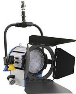
Die Scheinwerfer der Ultimo Blue Cap Serie verfügen über Fresnel-Linsen und stufenlos verstellbaren Lichtkegel. Lieferbar als 300/500W – 650W – 1000W – 2000W Version. Komplett ausgestattet mit Farbrahmen, Schutzgitter, 4-fach Torblende, 10/16mm Hülse, Schukoanschlusskabel mit Schnurschalter. Die S-Serie ist stangenbedienbar (horizontal – vertikal – Focus).
