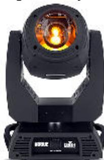
Moving Head Hybrid mit 330 Watt Osram Sirius Leuchtmittel. Im Beam-Mode erreicht der Rogue Nadelbeams von 1-4,5°, im Spot-Mode reicht der Zoom von 5-19°. Features: Farbrad, 14 statische und 9 rotierbare Gobos, 2x Prisma, Frost, Dimmer, Shutter, PAN (540°), TILT (260°). Der Rogue RH1 erzeugt bei 5° Zoom auf 5 Meter eine unglaubliche Helligkeit von 111.000 Lux.
