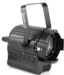
Professioneller Par-Scheinwerfer für MSR 575W Entladungslampn. Sockel GX 9,5. Fokussierung über Spindelantrieb. Mit Schutzgitter und austauschbaren Linsen ausgestattet. Integriertes elektronisches Vorschaltgerät . Dimmung von 40% bis 100% möglich.
